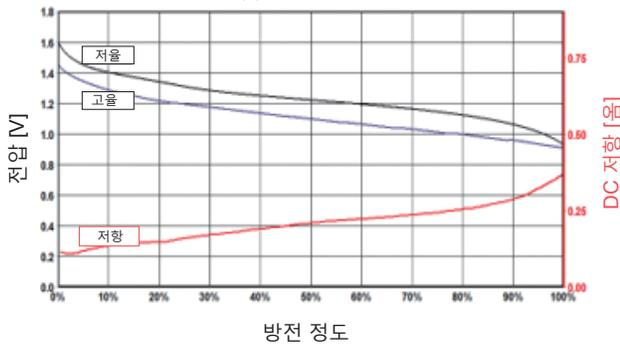
실제 사용 용량은 부하 및 작동 온도, 차단 전압에 따라 다릅니다. 에너지/서비스의 지속 시간을 예측하려면 다양한 부하 조건 하의 배터리 용량을 비교한 아래의 표와 방전 데이터를 참조하십시오.
